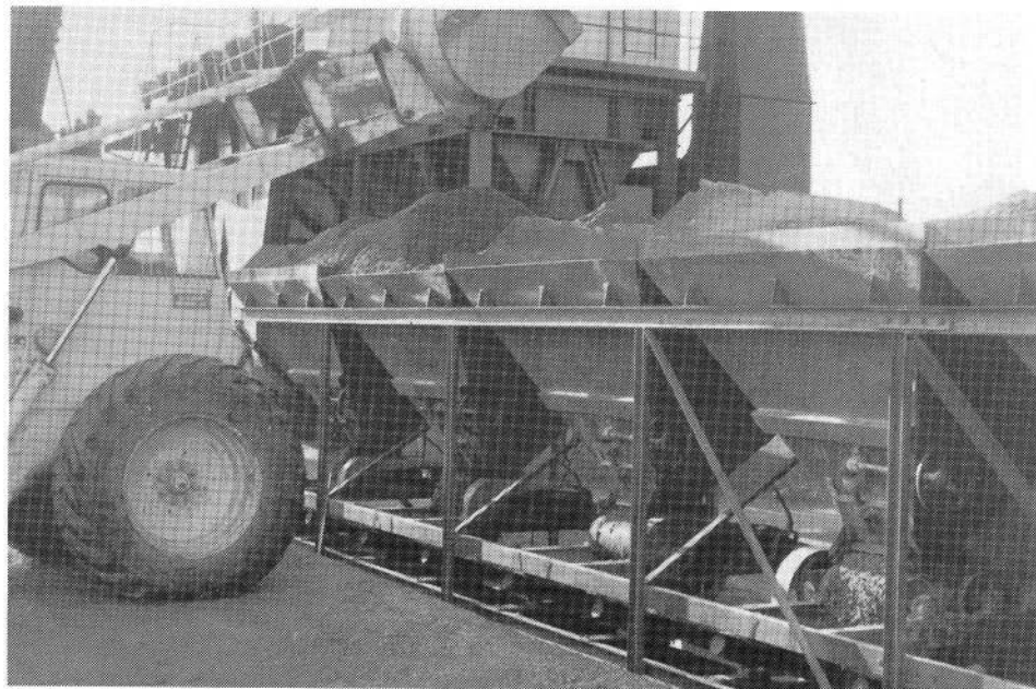
Fig. 2. Nærbillede af skuffeføderen (I) med stor gummiged klar til aflæsning af supplerende materiale.
