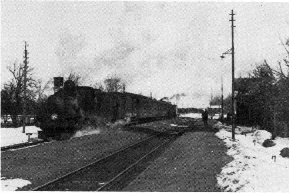
Tog 65 (109) i Tingsted på vej mod syd ca. 1935. Oprangeringen er: Mask (K) og fra København til Nykøbing F EH-DD samt BP til Nakskov, plus yderligere BN-CKK og godsvogne. Bemærk røgen fra varmekedlen i CKK-vognen.
