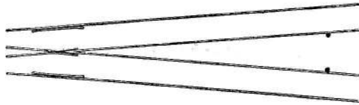
Fig. 87. Spor med Frispormærker af Porcelæn.
