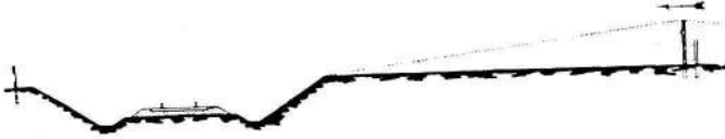
Fig. 75. Svelleskærm med Snebælte.
