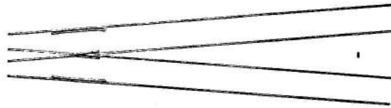
Fig. 85. Spor med Frispormærke af Træ.
