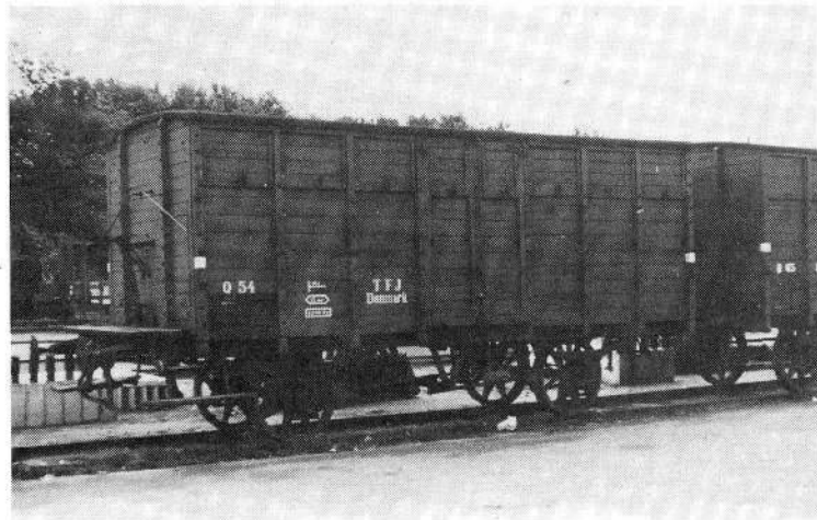
TFJ Q 54. Håndstænger ved 5. plankemellemrum. Se teksten side 168
