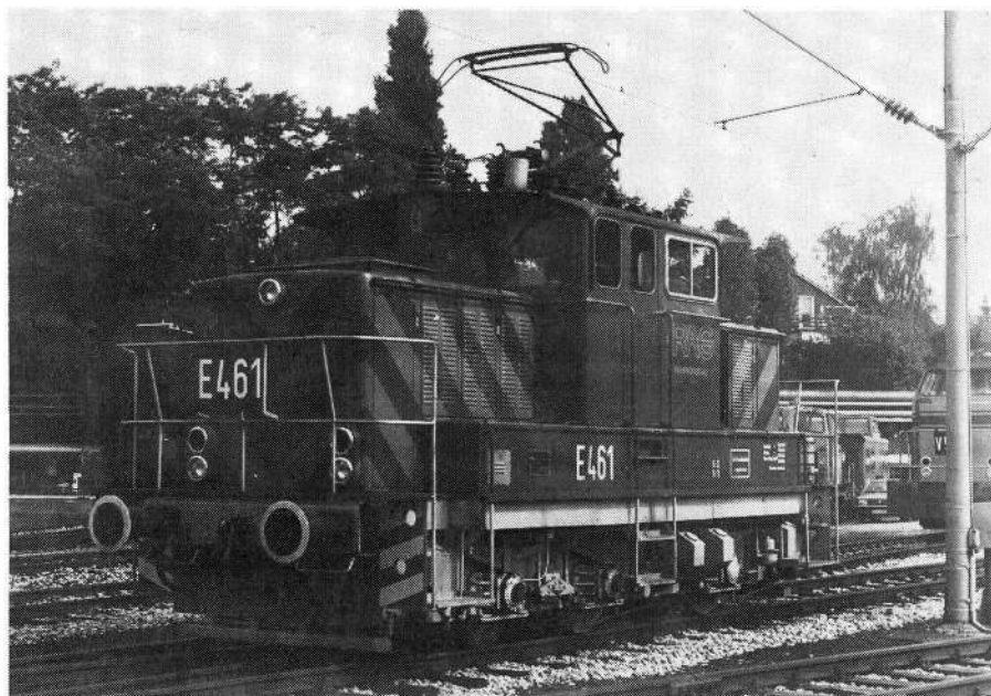
Linke-Hofmann-Buschs Ewald-type, Ruhrkohle E 461, LHB 3118/1964 i Gladbeck, 25. juni 1982. Da lokoet ikke er en standardtype, har det kun en lokaltypebetegnelse. I 1981 er lokoet på RAGs værksted i Gladbeck forsynet med vekselstrøms-teknik. LHB stammer oprindeligt fra Breslau, men genopstod efter krigen i Salzgitter, og firmaet er ikke meget kendt i Danmark. Det noget ufikse ydre er bevaret ved ombygningen, der således kun har omfattet de ædlere dele (indmaden).
