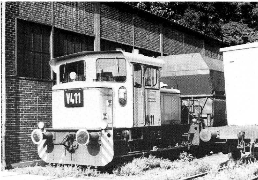
Fig 5: RAG V 411, Henschel 31088 /1965 af typen DHG 160, en lille to-koblet dieselhydraulisk maskine på 118 kW (160 hk). Lokoet rangerer som regel på værkstedet. Foto: GB 1979.
