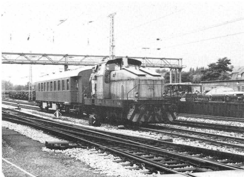
Fig. 9: RAG V 338, Henschel 31072 /1965, type DHG 500, dieselhydraulisk, 60 t, 338 kW. Lokoet ses her i Gladbeck med persontog: en RAG-ejet DB-privatvogn indrettet som rullende mødelokale og spisevogn. Bagperronen var indrettet som et lille køkken, hvor en kombineret kok/tjener kunne anrette en mindre frokost. Foto: BH 1981.
