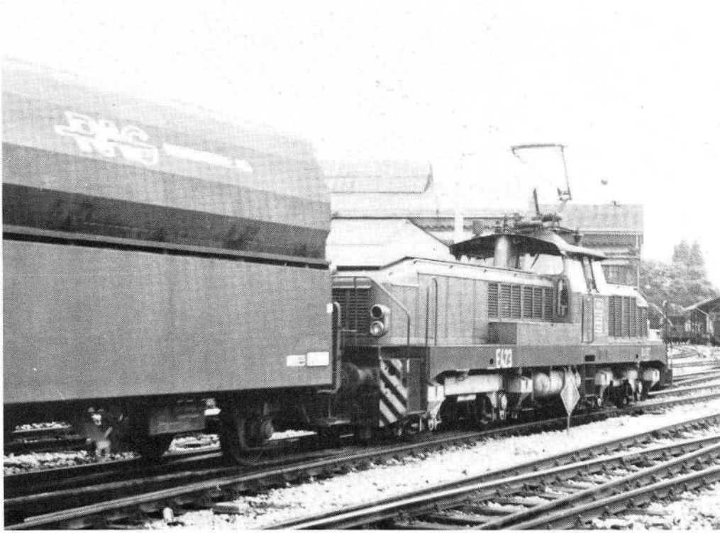
Fig. 4: RAG E 423, Henschel 31125 /1966. Samme kvalifikationer som E 407. Typen her kaldes Rheinstahl, og den eksisterer i ni eksemplarer, idet dog kun fire er fire-akslede. Heraf skulle to af de største (422 og 424) i begyndelsen af 1982 være totalskadede efter uheld. Lokoet passerer her forbi værkstedet med et kultog. Foto: BH 1981.
