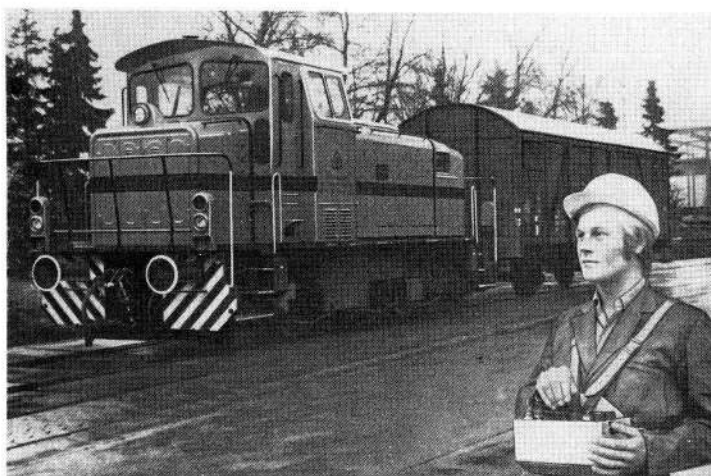
Fig. 4: FKH V 68, MAK 500 070/1974, type G 500 C. "Fører/rangerleder" ses til højre med sin 2,5 kg tunge radiosender, der både kan manøvrere lokomotivet og modtage returmeldinger f.eks. om olietryk. (Henschel markedsfører et tilsvarende lokomotiv, men helt uden betjeningsudstyr i "førerhuset", der udelukkende fungerer som "velfærdslokale"). Arkiv: BH.
