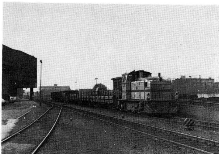
Fig. 3: FKH V 69, MAK 500 071/1974, type G 500 C. Skønt den er radiostyret, ses dog her både "fører og rangerleder". Foto: GB 18.3.81.
