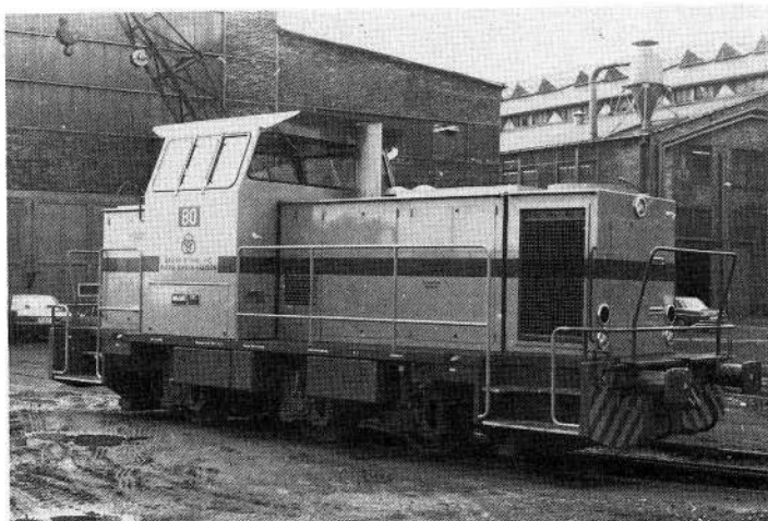
Fig. 7: FKH V 80, MAK 700 042/1980. Type DE 501. Overbygningen er åbenbart ikke symmetrisk. Denne side har en stor udluftningsåbning. Foto: GB 18.3.81.
