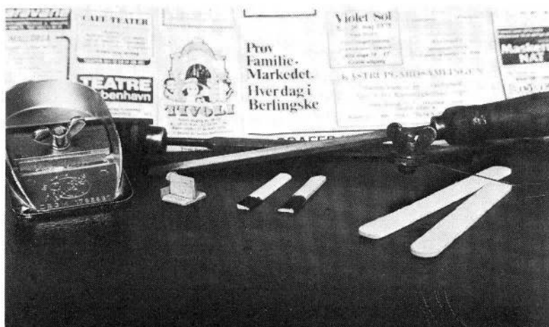
Dele til fremstilling af sofaer, høvl, file og løvsav. Til højre trælist, i midten ryglæn- og sædeprofiler, til venstre færdig sofa.
